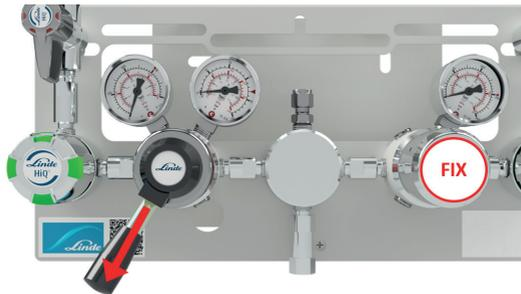
Durch das Drehen des Hebels nach links bis zum Anschlag wird der Hinterdruck des linken Druckminderers höher eingestellt (ca. 2 bar) als der Hinterdruck des rechten Druckminderers. Die Entspannungsstation entleert dadurch zuerst die Gebinde, welche an der linken Stationsseite angeschlossen sind.
