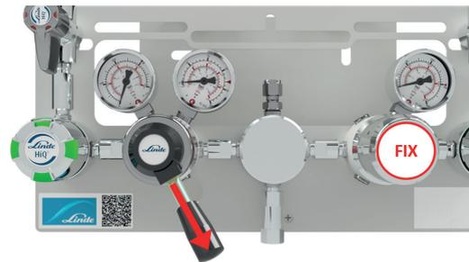
Durch das Drehen des Hebels nach rechts bis zum Anschlag wird der Hinterdruck des linken Druckminderers niedriger eingestellt (ca. 2 bar) als der Hinterdruck des rechten Druckminderers. Die Entspannungsstation entleert dadurch zuerst die Gebinde, welche an der rechten Stationsseite angeschlossen sind.
